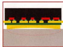
■ Bild 4: Spaltbildung durch thermische Verformung
