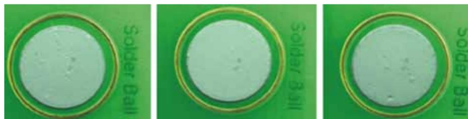
**Bild 3:** TPC-Z-PC-P Druckbilder (Durchmesser 7 mm) nach 30 min, 1 h und 2 h Standzeit
